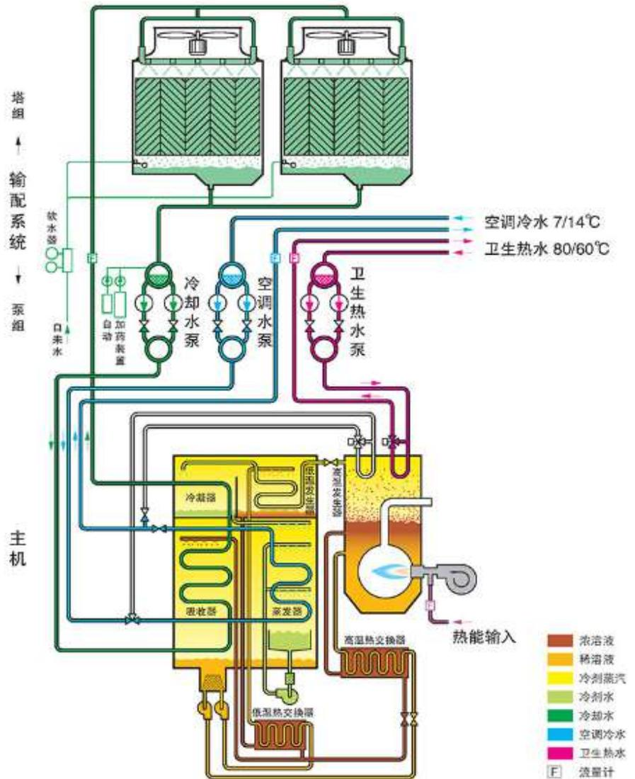
这种吸收式循环系统，系统的电力消耗非常低，其主要消耗于循环溴化锂溶液的泵功及控制上，与所输出的能量相比，所占比例非常小。吸收式冷冻机的主要能源是热源，通常分为直接燃烧加热和间接加热两种形式来提供热源。直接加热的吸收式冷冻机在高温发生器中配置一个燃烧器来提供热源，而间接加热的吸收式冷冻机没有备用燃烧器。间接加热吸收式冷冻机依靠外部热源来供热，例如：废气、废水，或者是太阳能加热水。热水热源温度可低至70°C，凡是有废热能源和冷却要求的地方，吸收式冷冻机都有用武之地。
