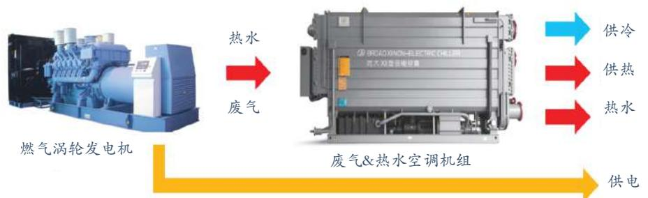
输入的热能将发生器的溴化锂溶液加热到 $140^{\circ}\text{C}$ ，用来产生水蒸气，水蒸气通过冷凝器被冷却水冷却凝结成水。当制冷剂液体进入蒸发器这个高真空环境，制冷剂温度立即降至 $5^{\circ}\text{C}$ ，并喷洒在蒸发器管上，使冷冻水冷却，温度从 $14^{\circ}\text{C}$ 降到 $7^{\circ}\text{C}$ 。制冷剂液体从空调系统中吸收热量而蒸发，然后通过发电机被溴化锂浓溶液吸收热量，并将热量传递给冷冻水，释放到大气中。变稀的溴化锂溶液再被泵到高温和低温发生器，再次被加热，产生水蒸气，如此不断循环。
